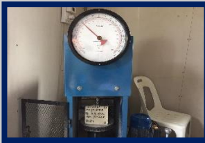
งานทดสอบกำลังอัดตัวอย่างคอนกรีตของงานเสาเข็มเจาะ ใช้งาน สะพานข้ามคลองเปรี้ง ช่วง กม.15+667และงาน Coring ก้อนตัวอย่าง Asphaltic Concrete Binder Course ระหว่างช่วง กม.19+720 ถึง กม.20+389 และ กม.14+750 ถึง กม.14+363 LT
