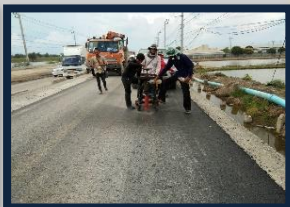
งานทดสอบกำลังอัดตัวอย่างคอนกรีตของงานเสาเข็มเจาะ ใช้งาน สะพานข้ามคลองเปรี้ง ช่วง กม.15+667และงาน Coring ก้อนตัวอย่าง Asphaltic Concrete Binder Course ระหว่างช่วง กม.19+720 ถึง กม.20+389 และ กม.14+750 ถึง กม.14+363 LT
